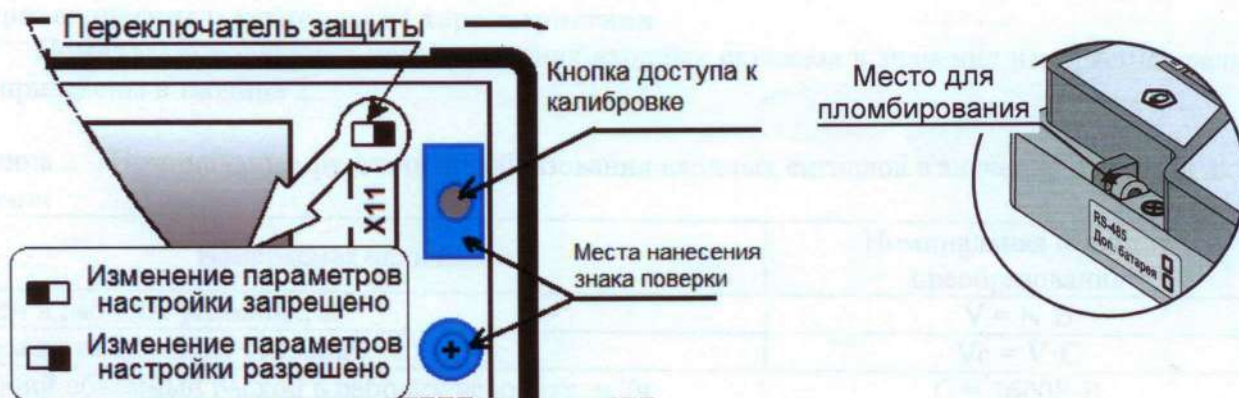
Рисунок 2 – Места пломбирования вычислителя
